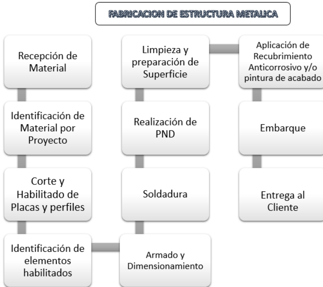
Ilustración 1 Proceso de la fabricación de estructuras metálicas; Fuente: área de calidad planta metalco Irapuato. (meta, 2019)
