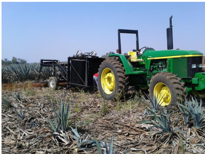
Figura 2. Cosechadora en posición de trabajo
